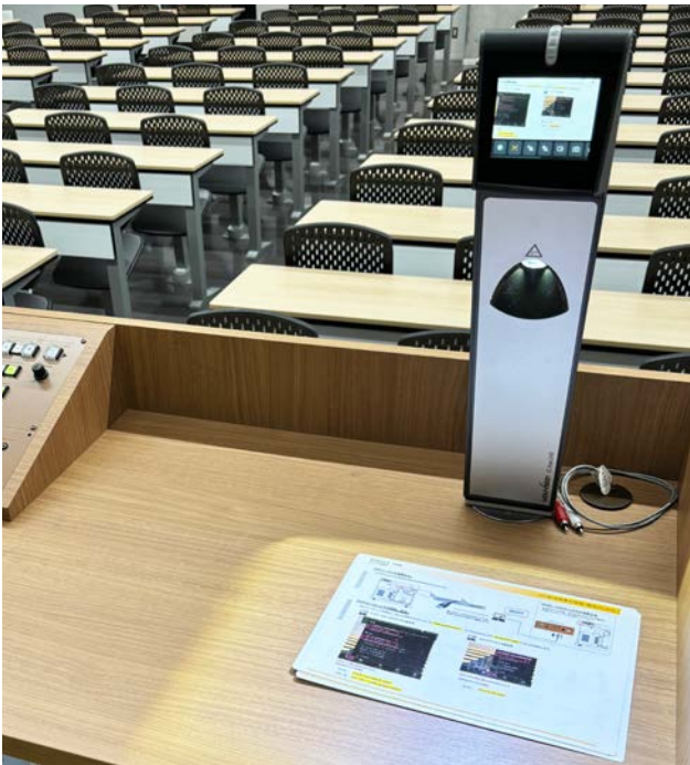
統合作業プレートのないVZ-3neo.UHDはデスクトップに直接取り付けられます。
