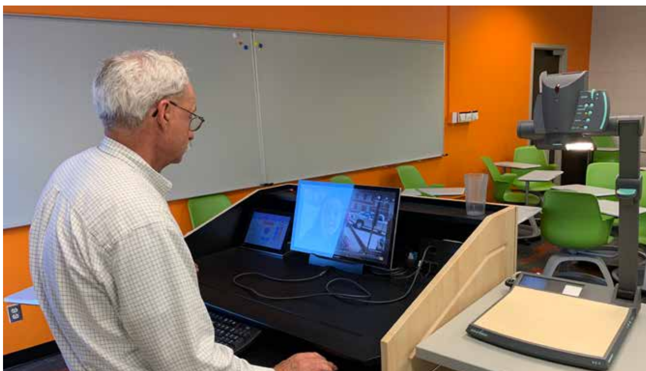
Sicht vom Rednerpult mit Cynap, Touchscreen-Controller, AMX-Bedienfeld und WolfVision Visualizer.
