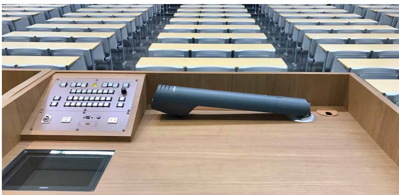
Der VZ-3neo Visualizer ist so konfiguriert, dass er zur platzsparenden und bequemen Aufbewahrung an der Tokyo Keizai Universität um 90° auf die linke Seite heruntergeklappt werden kann.
