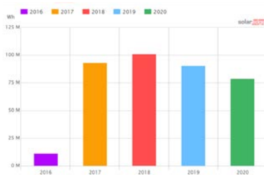
Erzeugte Energie mit der eigenen Photovoltaikanlage von Ende 2016 bis August 2020 (in MWh).
