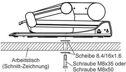
Der Visualizer kann mit der mitgelieferten Tisch-Fixiereinheit an einem Tisch festgeschraubt werden um das Risiko eines Diebstahls zu minimieren.
