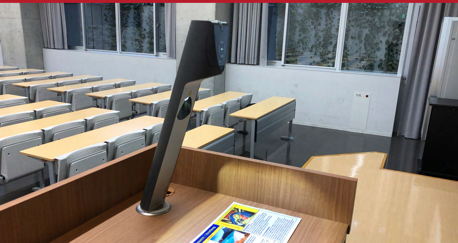
東京経済大学: 教卓に直接取付けられたワーキングプレート非一体型VZ-3neo。
