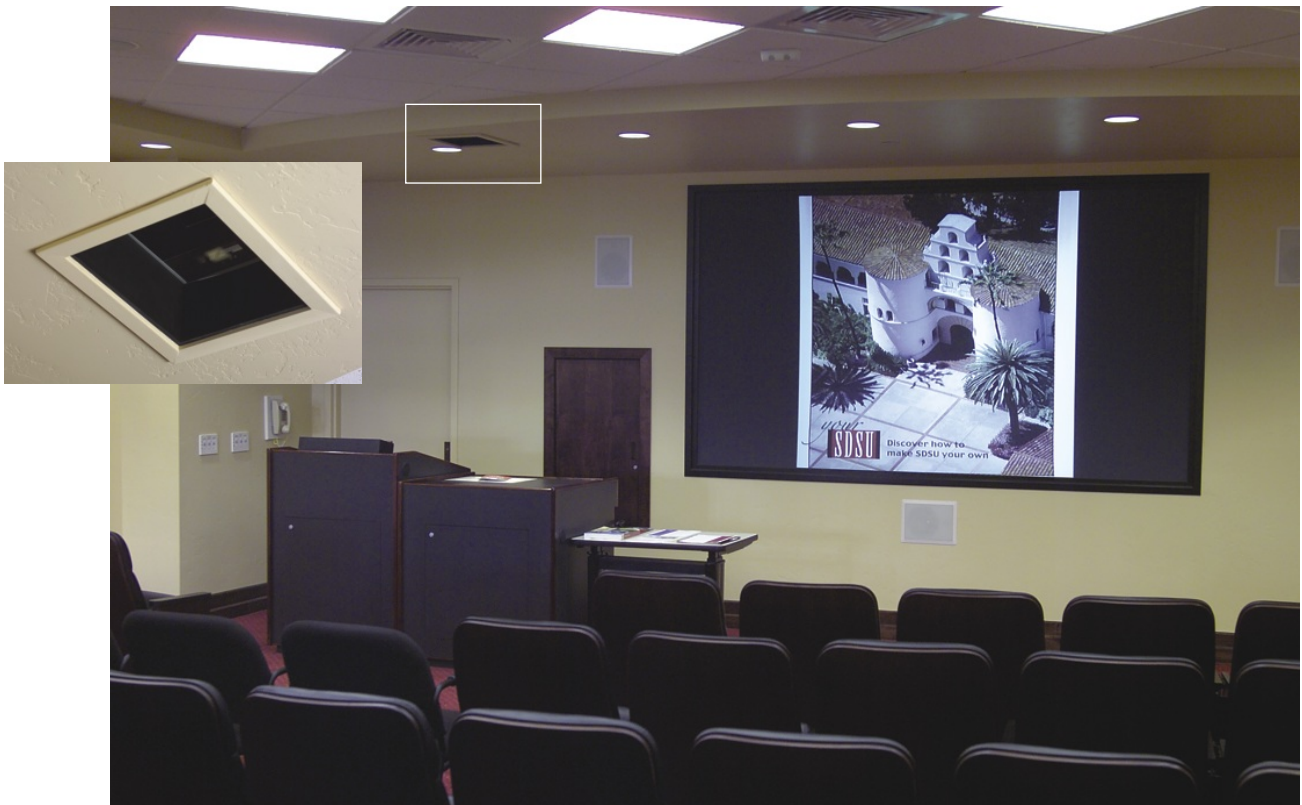
Präsentationsraum mit modernster Technologie; Nahaufnahme eines High End Decken Visualizers (oben links), der unsichtbar in die Decke eingebaut ist. Das weiße Kästchen zeigt den Visualizer, wie er über dem Pult installiert ist.
